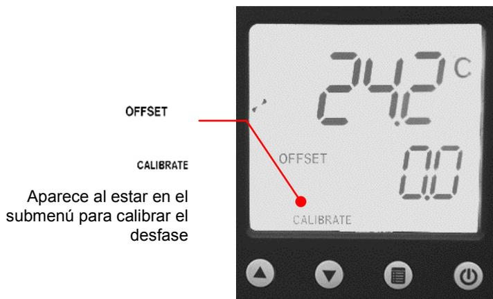
**Para acceder:** Pulse la tecla
