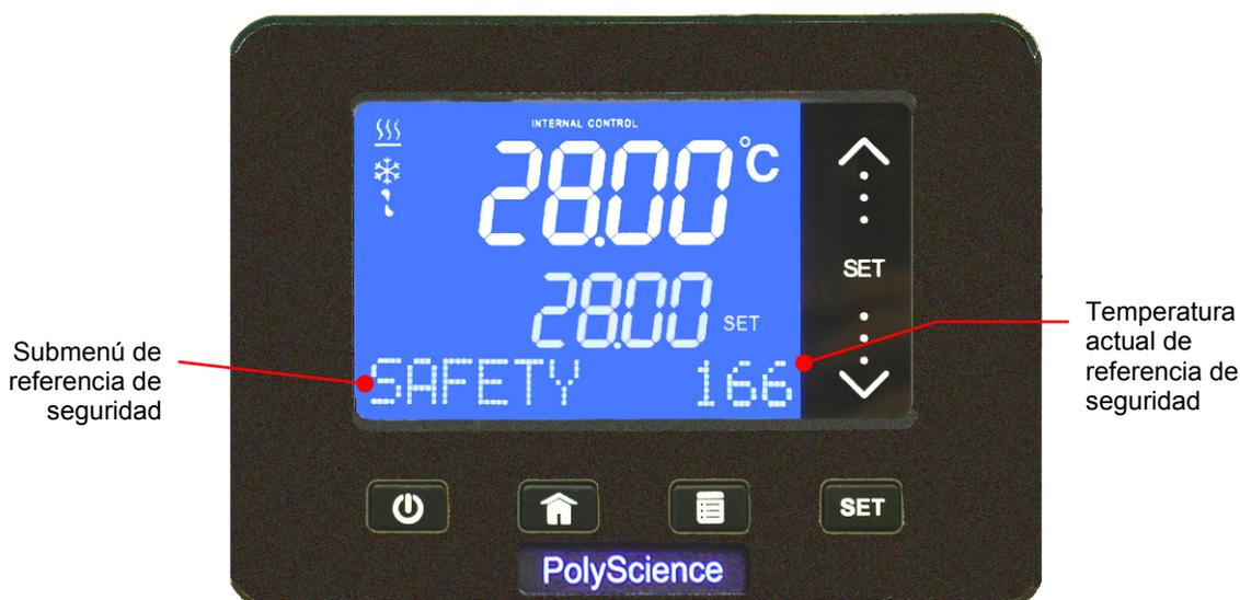
2. Utilizando un destornillador de cabeza Philips N.º 1, gire el termostato de referencia de seguridad en la parte posterior del controlador de temperatura hasta mostrarse la temperatura de referencia de seguridad deseada (hacia la derecha para aumentar; hacia la izquierda para disminuir).
