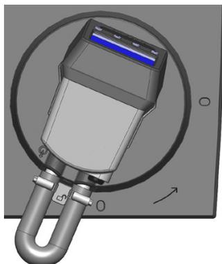
3. 逆时针旋转温度控制器，直到锁定片与顶层甲板上的凹口齿合。
