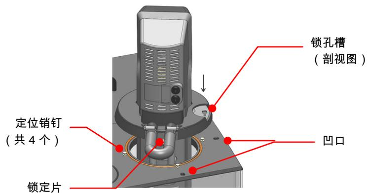
2. 轻轻旋转温度控制器，直到它下降到定位销钉上。
