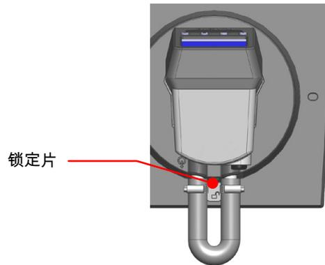
2. 顺时针旋转温度控制器，直到它停止（大于 0.75 英寸/1.9 厘米）。
