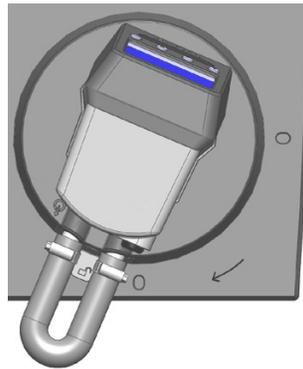
3. 垂直提升控制器，将其提出循环器顶层甲板的开口。
