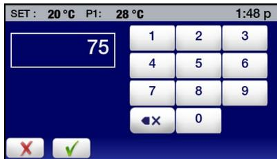
**Valor máximo** — A temperaturas del baño superiores a este valor, la válvula estará abierta al 100%. El valor máximo puede fijarse de 40° a 80°C.
