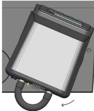
3. Levante el controlador directamente hacia arriba para sacarlo por la abertura de la plataforma superior del circulador.
