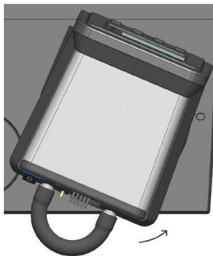
3. Gire el controlador de temperatura hacia la izquierda hasta que la lengüeta de bloqueo se enganche en la hendidura de la plataforma superior.
